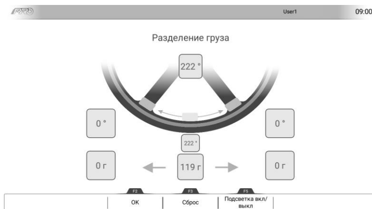
Рисунок 3.27 – Разделение балансировочных грузов
