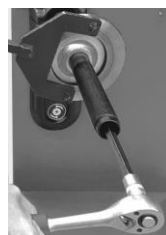
Рисунок 2 – Затяжка вала с помощью ключа
