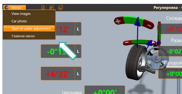
Рисунок 3.32 – Запуск режима регулировки продольного наклона шкворня
