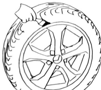
Рисунок 4.2 – Нанесение смазки на борт шины
