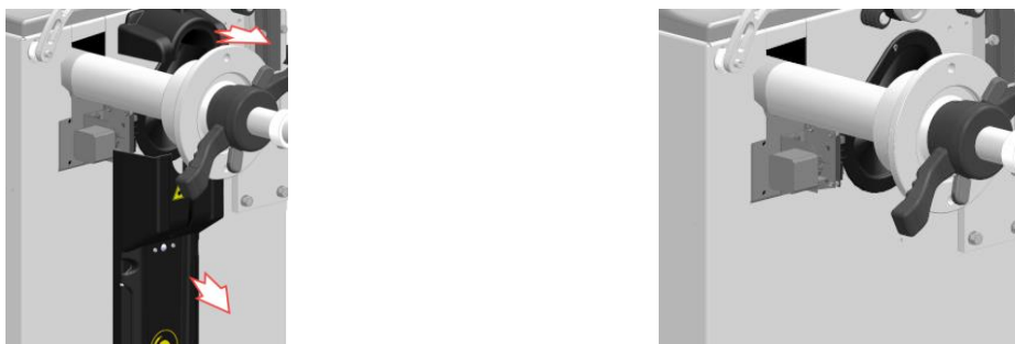
Рисунок 5.25 – Демонтаж защитных панелей с корпуса
